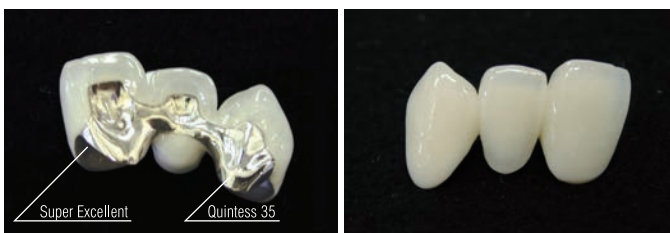
Результат теста на образование трещин на металлокерамическом каркасе с использованием комбинации различных сплавов
